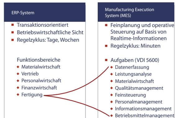
Bild 1: Umfang der Funktionalität von Manufacturing Execution Systemen.
